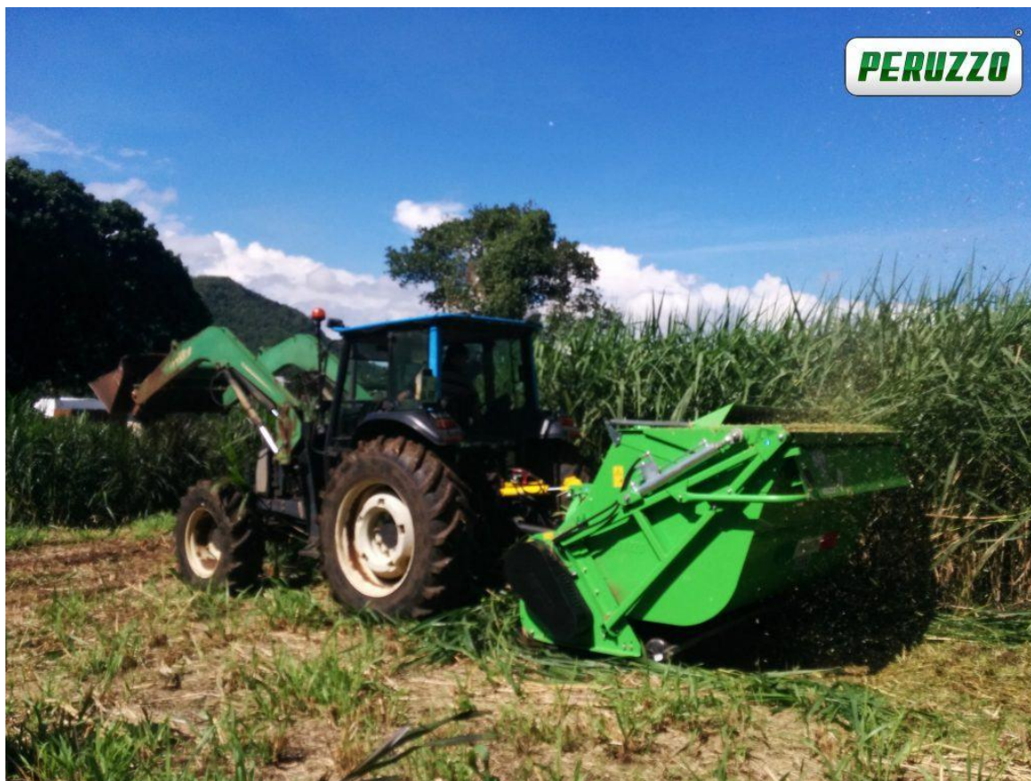
Fig. 3. Macchina operatrice trincia dotato di sistema di raccolta del materiale vegetale tagliato
